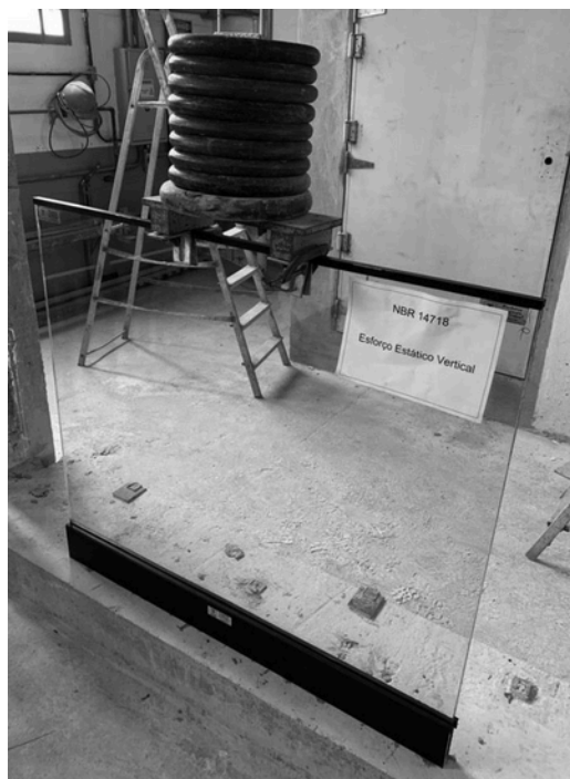
Figura 5 – Ensaio com sentido de aplicação de esforço vertical
