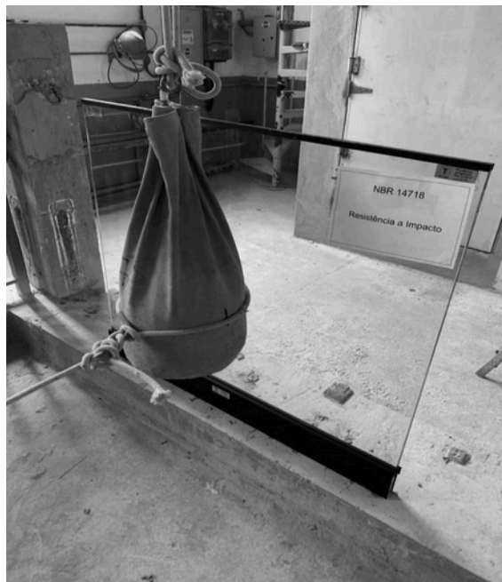
Figuras 6 – Ensaio para determinação de resistência a impacto
